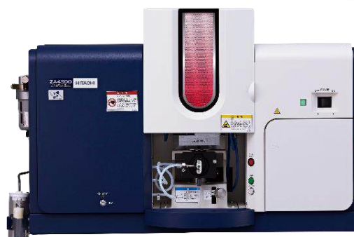
Máy quang phổ hấp thụ nguyên tử AAS hệ lửa tuần tự, hiệu chỉnh nền Zeeman Model ZA4800
