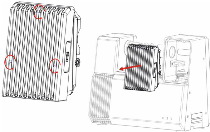
Figure 7-1. Detector module
