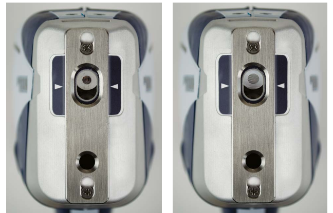
S1 TITAN với đầu dò bị hỏng (Trái) và đầu dò được bảo vệ bởi tấm TITAN DETECTOR SHIELD (Phải)
