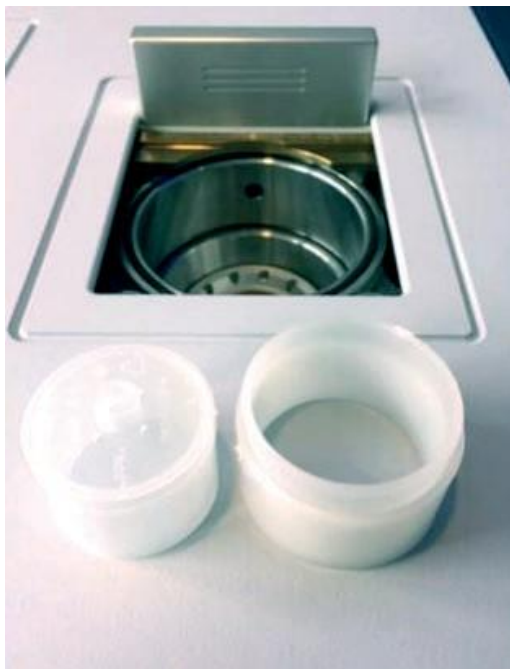
Hình 3: Cốc chứa mẫu lỏng (Ø 40 mm) bên trái và cốc SampleCare rộng hơn (Ø 51 mm) bên phải
