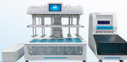
RT614-ST – 14 vị trí kết hợp bộ lấy mẫu bơm Piston
